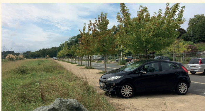
Ce parking estival est constitué d'un revêtement en sable stabilisé sur les places de stationnement.
