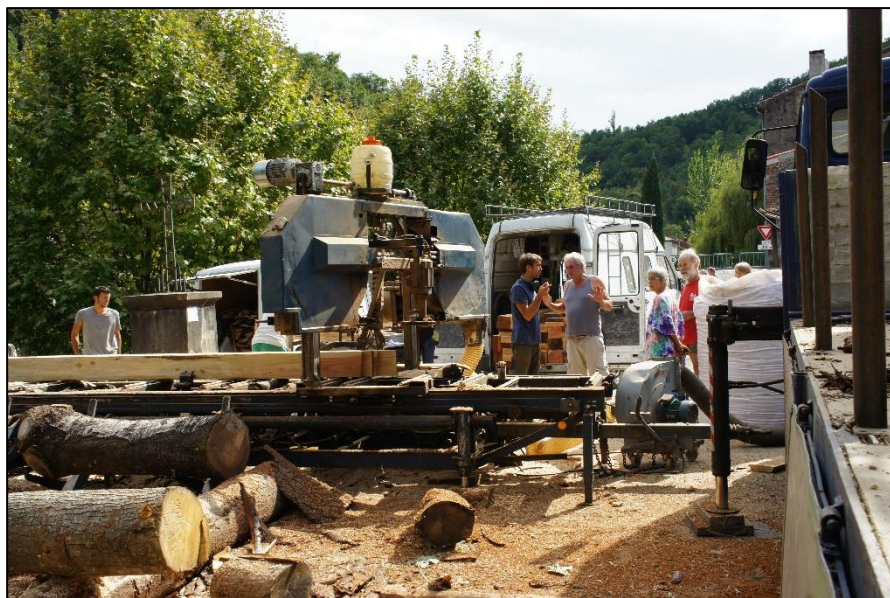
Chantier de sciage à façon collectif avec une scierie mobile à Pailhès. © PNRPA
